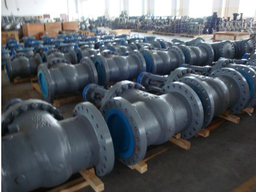
坚固耐用的波纹管密封设计，保证阀杆的零泄漏，提供无需维护的条件。气体介质阀座采用PTFE软密封材料提高本阀的密封性。耐高温≤425℃阀座采用锥面硬密封。达到气密性能零泄漏。随着人工成本的不断上涨减轻劳动力是越来越多的企业所希望的，有这样的波纹管截止阀可以让工人开关更轻松产品使用的寿命更长密封性能更好的产品，有理由相信它的前景会越来越广阔。电动截止阀的特点：流体阻力小，其阻力系数与同长度的管段相等。结构简单、体积小、重量轻。闸截止闸截止蝶阀采用软密封结构具有开关轻巧、耐腐蚀、密封可靠、弹性记忆佳及使用寿命长等明显特点。电动闸阀维护咨询
